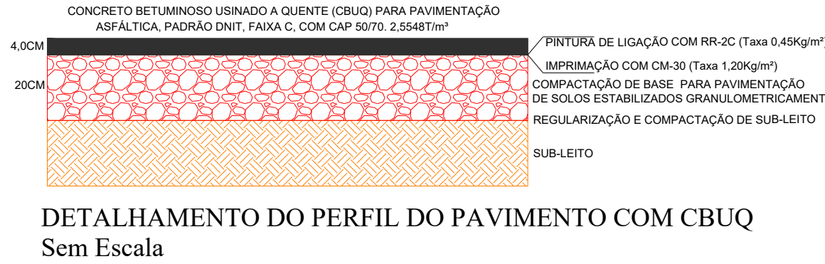
DETALHAMENTO DO PERFIL DO PAVIMENTO COM CBUQ Sem Escala
